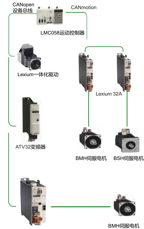
Lexium 32M伺服驱动器 采用CANopen和CANmotion设备总线的控制系统架构示例
