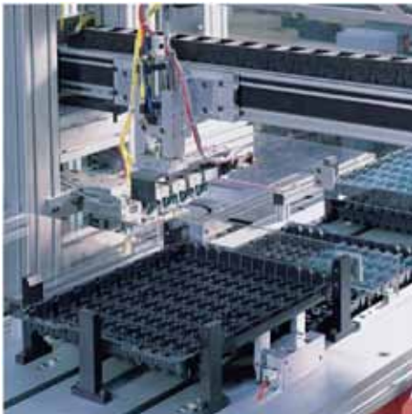
LXM 32伺服驱动器控制拾放式机器人
